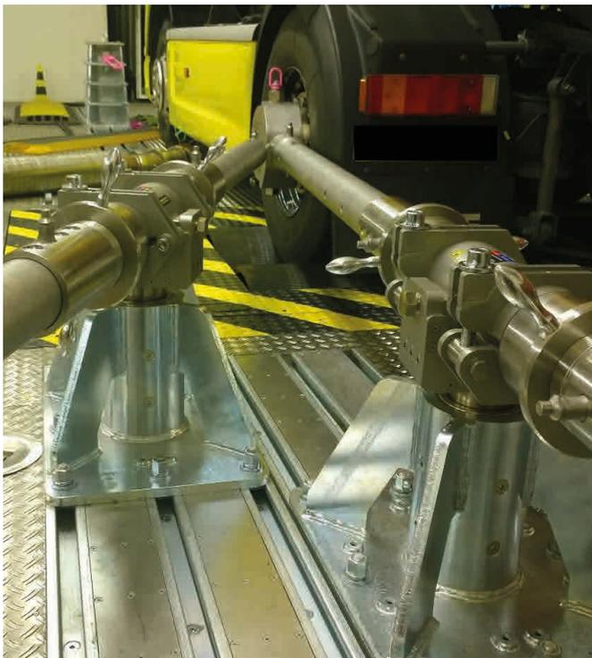
Diese Variante ist eine Weiterentwicklung des bewährten Systems für PKW und ist geeignet für LKW und Nutzfahrzeuge über 7,5 t. Mit der Auslegung auf eine maximale Achslast von 11 t sind hier alle gängigen Nutzfahrzeuge im europäischen Raum abgedeckt.
