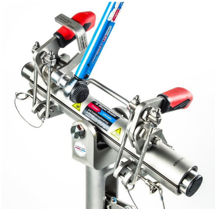
Abbildung 30: Einstellwerkzeug zur Einstellung der Klemmkraft
